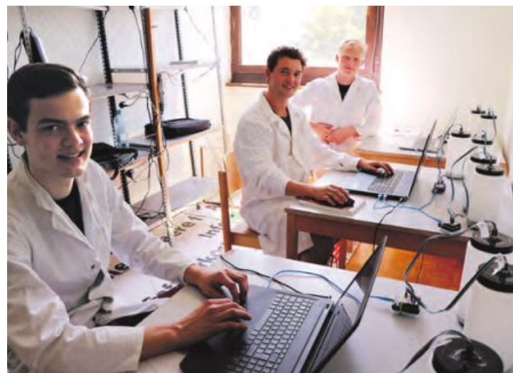
Die Ammoniakabgasung wird mit Messsensoren am Deckel (rechts) gemessen. Die Messdaten werden am Computer dargestellt. Fotos: Kronreif
